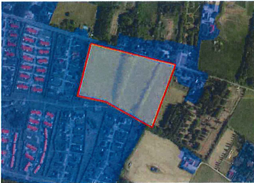
Figur 3: Blå markering viser separatkloakering.
